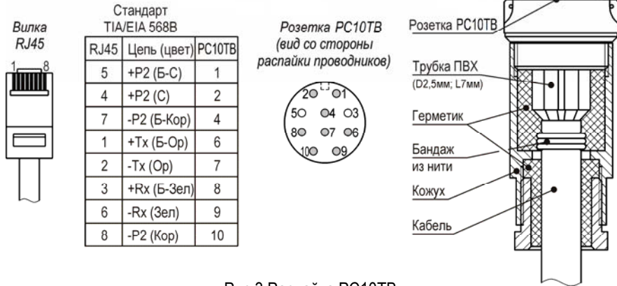
Рис.3 Распайка PC10TB
